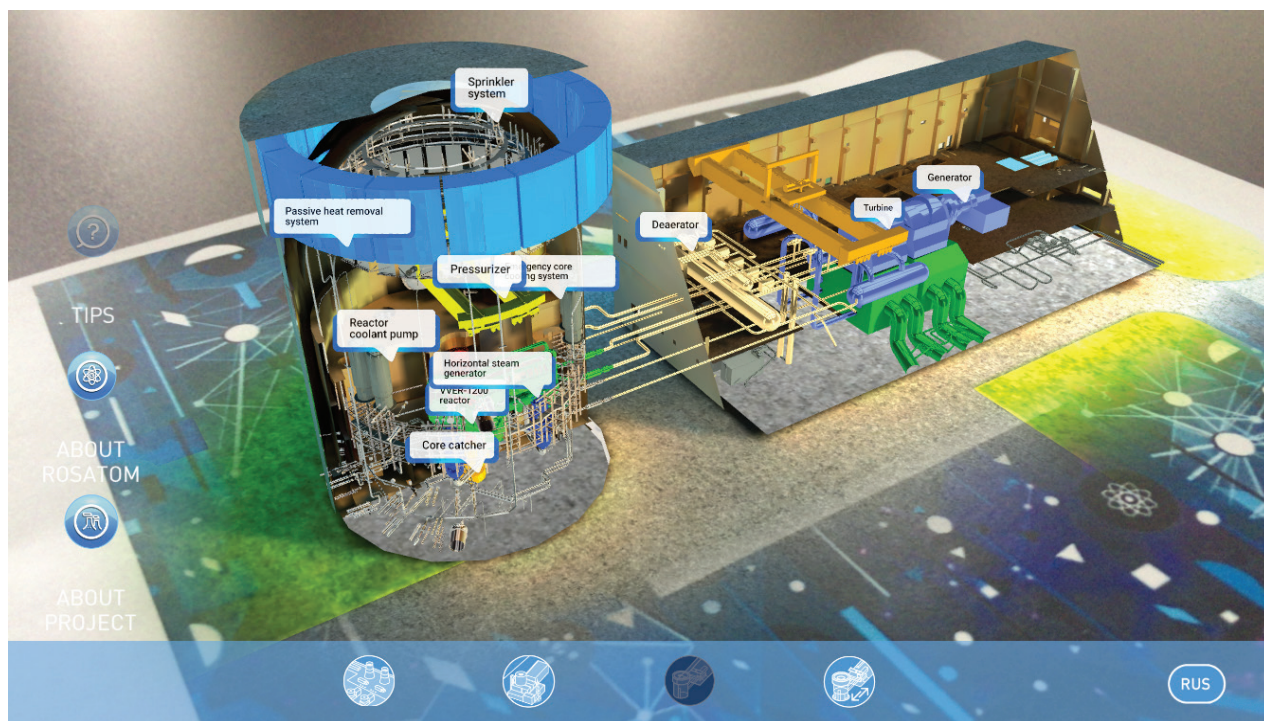
Fot. 4. WWER-1200 przekrój (widać między innymi systemy spryskiwaczy, pasywnego usuwania ciepła i chwytacz rdzenia; zdjęcie ROSATOM)
