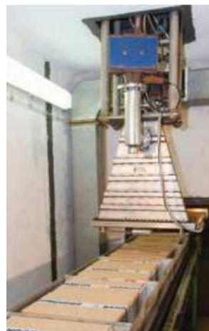
Akceleratorowa instalacja do przemysłowego wyjaławiania wyrobów medycznych, przeszczepów, implantów, opakowań itd.
